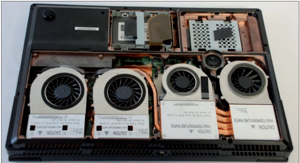
De vier ventilatoren die de componenten in de Panther 2.0 afkoelen.
